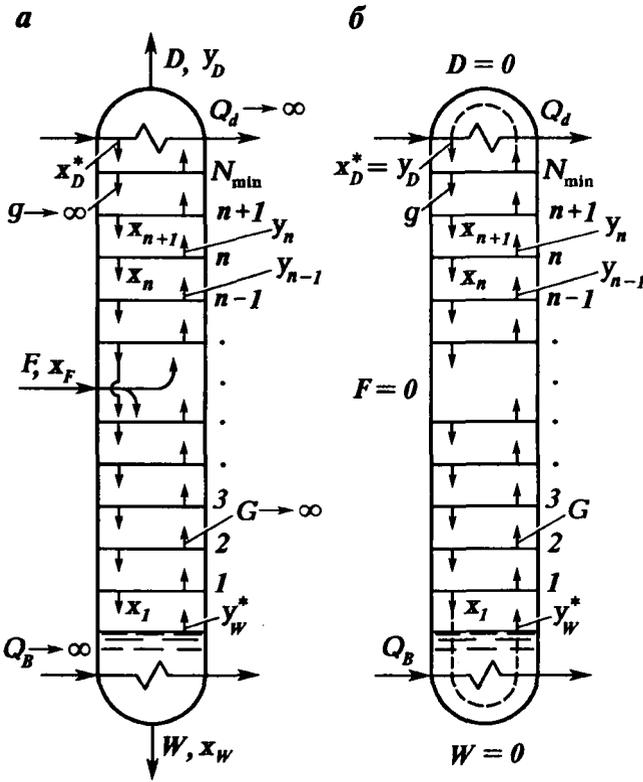
Рис. IV-19. Схема работы колонны с бесконечным флегмовым (паровым) числом:
